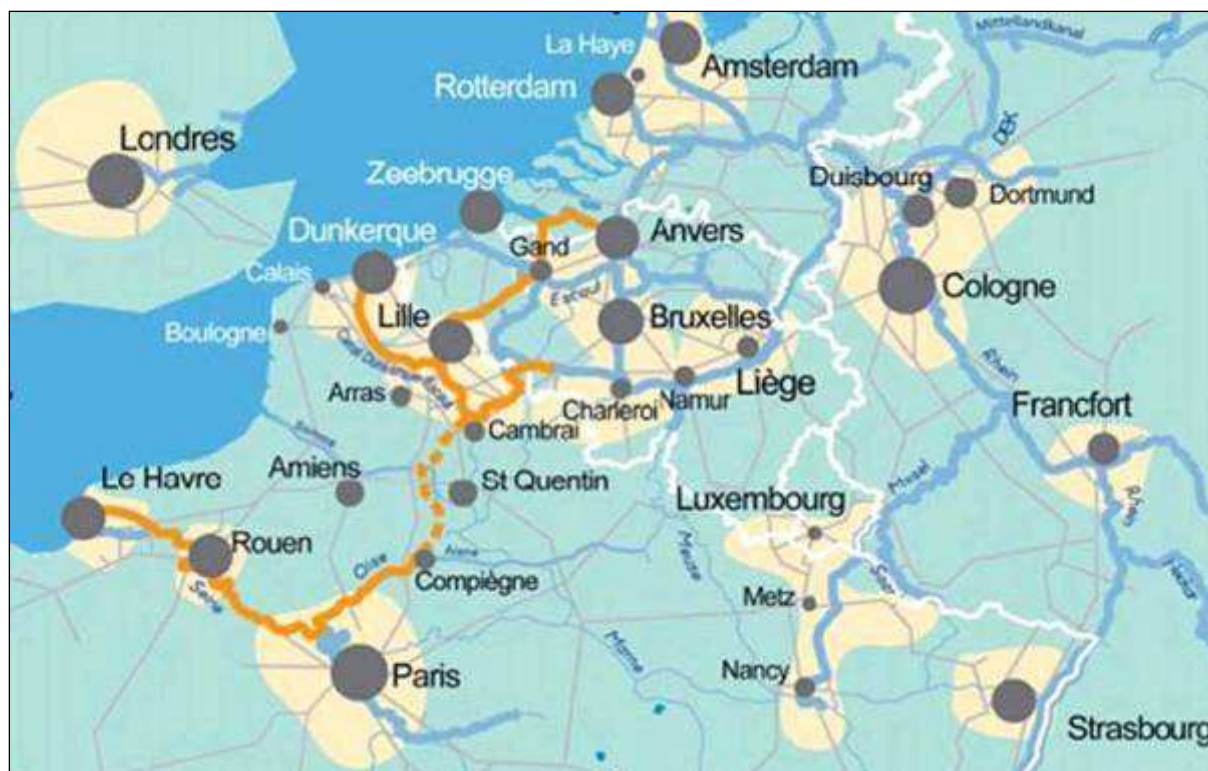
Figure II - 13 : Fret fluvial à grand gabarit en Europe et canal Seine-Nord-Europe (en pointillé)
